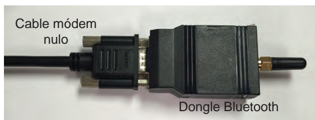
Figura SU-18: conexión de dongle al cable
