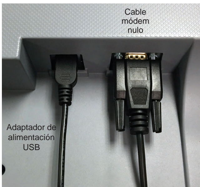
Figura SU-19: conexión de adaptador de alimentación USB y cable módem nulo
