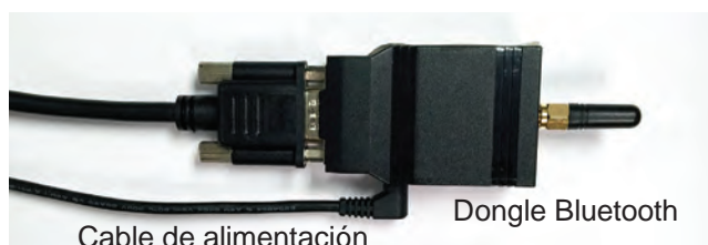
Figura SU-20: conexión de dongle al cable de alimentación
